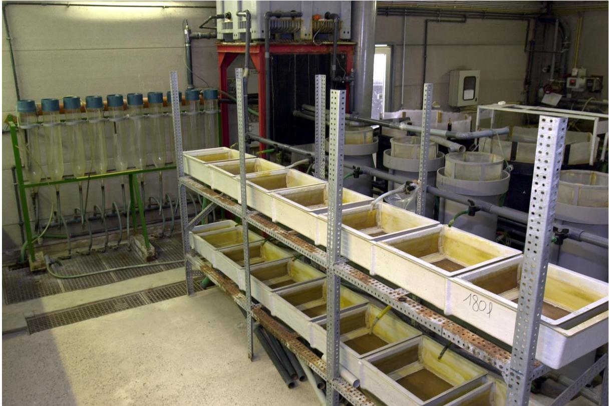
Photo 1 : Ecluserie en circuit fermé : dans le fond, batterie de bouteilles de Zoug au-dessus du filtre bactérien pour l'éclosion des œufs et château d'eau et à l'avant plan, bacs de larviculture avec leurs claies
