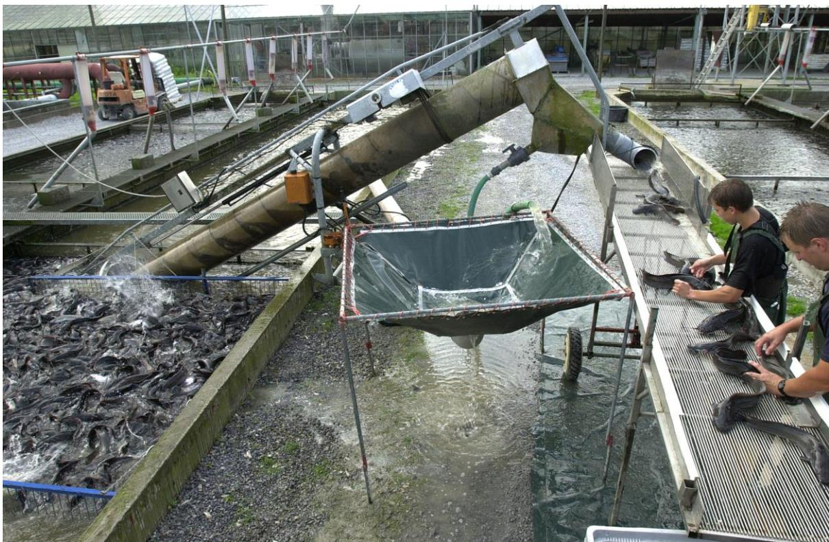
Photo 10 : Récolte et tri final des poissons chats pour la commercialisation : vis d'Archimède, toboggan, table d'égouttage et de triage
