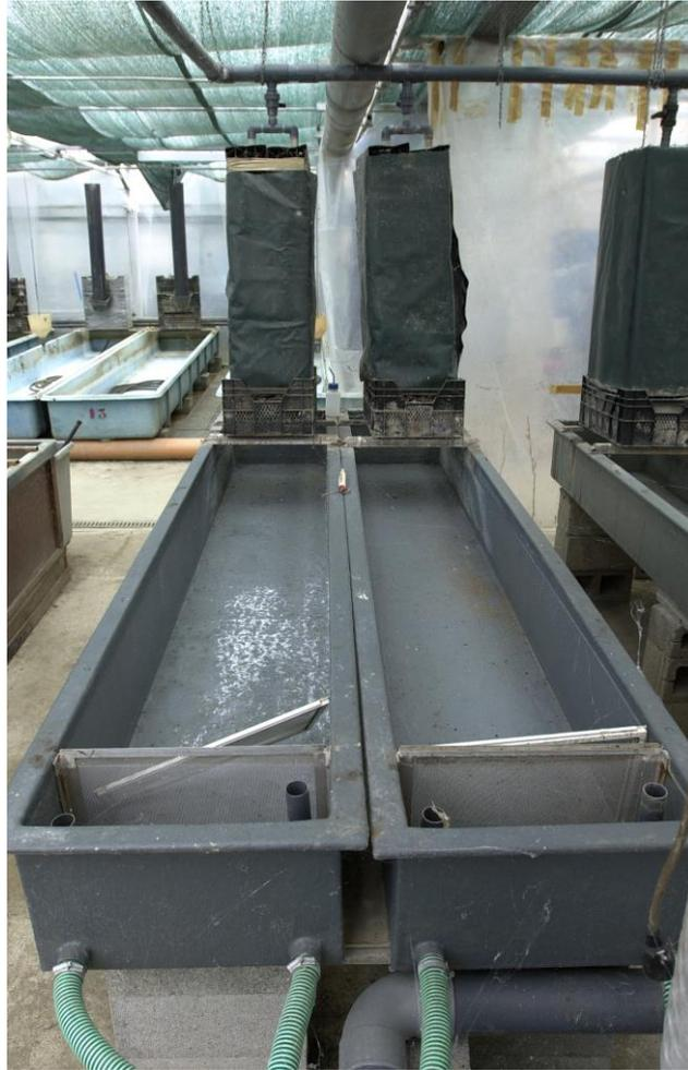
Photo 2 : Deux bassins de circuit fermé n° 2 (CF 2) avec leur tour d'épuration
