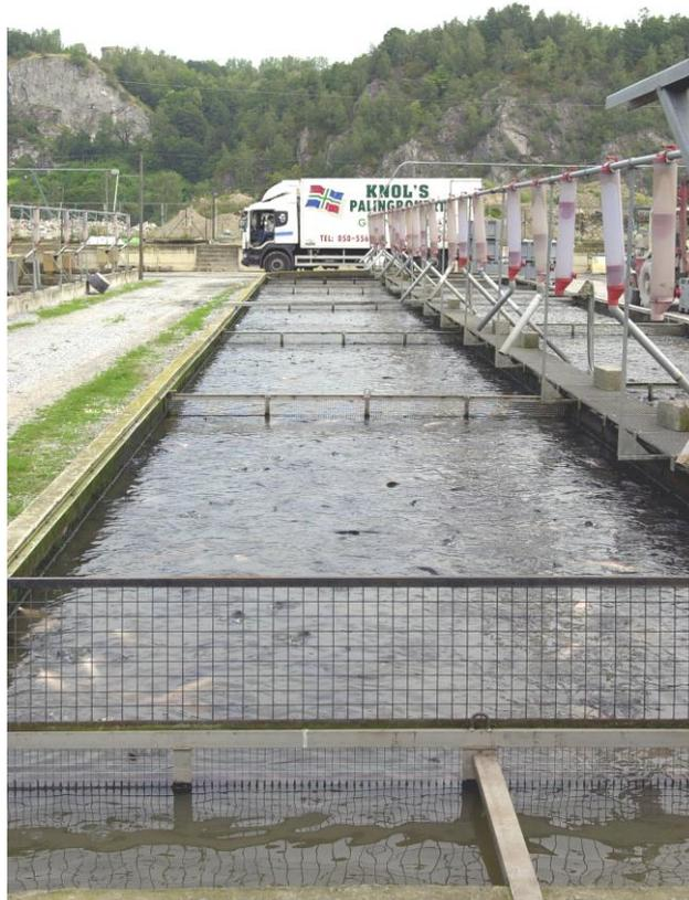
Photo 8 : Canal complet de 360 m<sup>3</sup> (raceway) avec grilles de séparation (10 à 12.000 poissons entre 2 grilles) et système de distribution automatique d'aliments (à droite)
