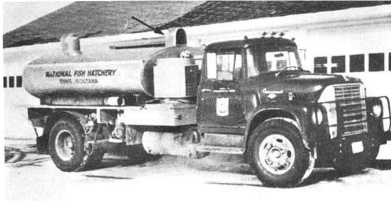
Figure 39 Cuve en aluminium de forme elliptique pourvue d'un groupe frigorifique installé à l'avant. L'aération est effectuée par des pompes à gaz et de l'oxygène pur. A l'avant et à l'arrière de la cuve (flèche) sont placés des ventilateurs aspirants pour l'évacuation du CO 2 (Piper et al. , 1982)
