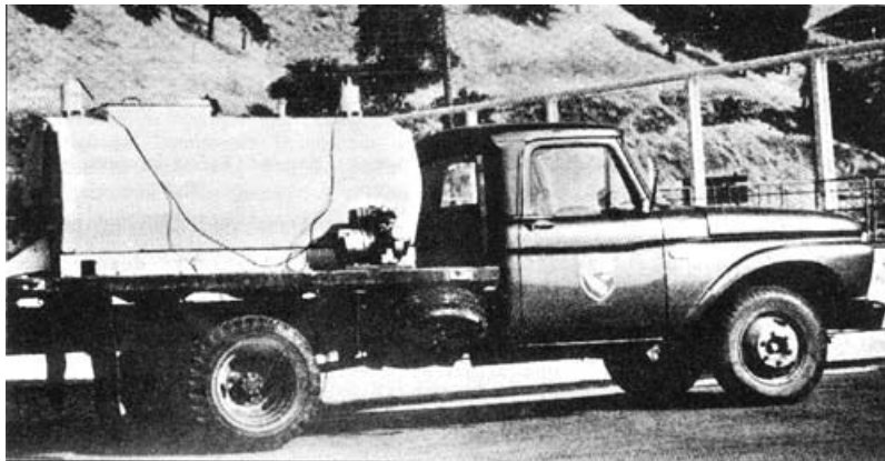
Figure 38 Bac de 1 800 litres destiné au transport du poisson et monté sur un camion-plateau. Il est pourvu à chacune de ses extrémités d'une petite pompe électrique actionnée par un générateur ou par une batterie très puissante qui vaporise l'eau en son centre. La température de l'eau y reste parfaitement constante (Leitritz et Lewis, 1976)
