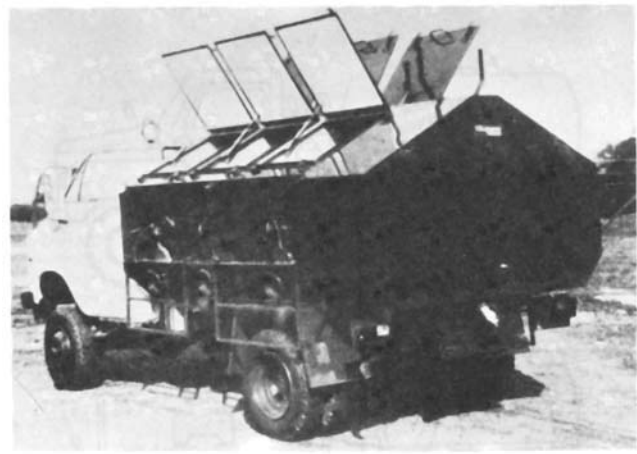
Figure 43 Véhicule d'une contenance de 2 227 litres pour le transport des poissons (BUCKINGHAM VEHICLES Ltd)
