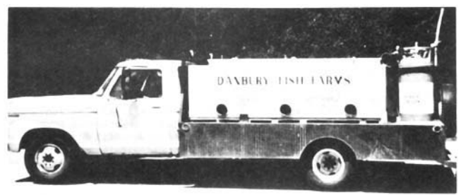
Figure 44 Véhicule pour le transport des poissons doté d'une installation d'alimentation en oxygène liquide, de valves contrôlant le débit de l'oxygène, d'agitateurs, de rampes latérales et d'un éclairage pour le transport de nuit (Johnson, 1979)
