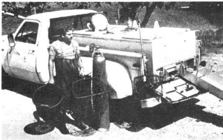
Figure 40 Petit camion pour le transport des poissons pourvu d'aérateurs et d'une bouteille d'oxygène de secours (Dupree et Huner, 1984)
