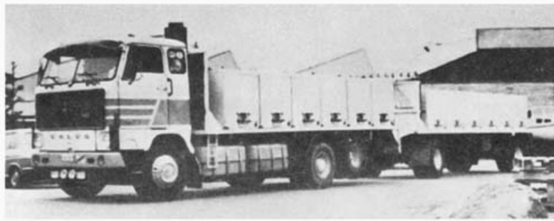
Figure 34 Installation de bacs sur un camion dont la capacité est d'environ 8 000 litres (15 000 litres lorsqu'on ajoute une remorque)
